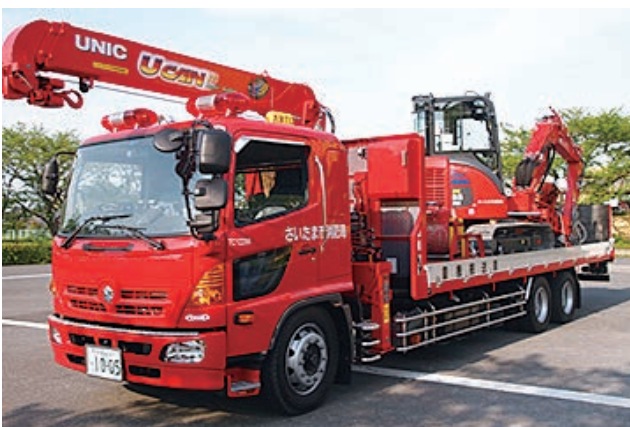
重機及び重機搬送車
